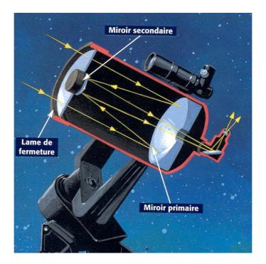
**Avantages**: Grâce au montage optique, le tube est très compact tout en disposant d'une longue focale bien adaptée à l'observation planétaire. Bon rapport qualité prix pour les 200 mm de diamètre. Instrument très polyvalent pour lequel on dispose d'un grand choix d'accessoires. Tube fermé.
