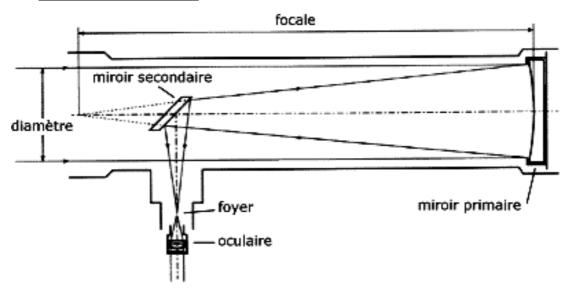
*Avantages*: Coût de fabrication peu élevé ce qui permet de réaliser des Newton en monture simple (les Dobsons) pour un prix très compétitif. Obstruction peu importante par rapport aux autres types de télescopes. Rapport F/D polyvalent qui fait du Newton un télescope aussi bien adapté au planétaire qu'au ciel profond.
