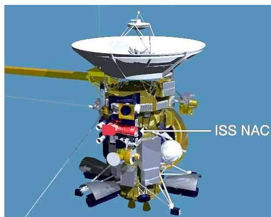
Le système ISS se compose de deux caméras appelées **NAC** (Narrow Angle Camera) et **WAC** (Wide Angle Camera), la première est destinée à faire des images avec une très haute résolution, comme une sorte de “zoom” puissant. Elle est capable de distinguer une pièce de 10 centimes d’euros à une distance de 4 km !!
